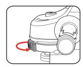
IF THE GUARD NUT IS OVER-TIGHTENED, THE GUARD LEVER WILL NOT BE ABLE TO CLOSE PROPERLY. IF THE GUARD NUT IS TOO LOOSE, THE GUARD LEVER WILL CLOSE BUT WILL NOT SECURELY FASTEN THE **GUARD TO THE SPINDLE NECK.**
