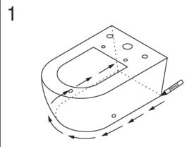
PLACE THE PAN INTO ITS DESIRED INSTALLATION POSITION. TRACE AROUND THE OUTSIDE OF YOUR PAN USING A PENCIL.
